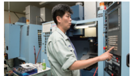
工作物を固定して、刃物を回転させて切削するマシニングセンター
