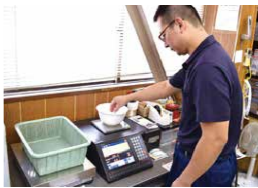
計量中の新井さん。重量によって個数だけでなく「欠け」などのチェックもしている
