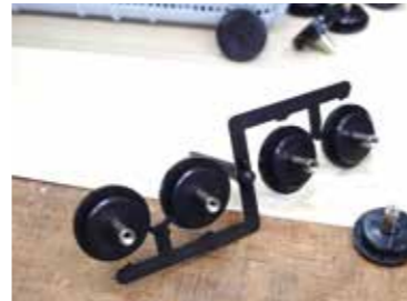
ランナー（軸）から、製品を外していく。作業は簡単だが、意外と作業者の個性が出るという
