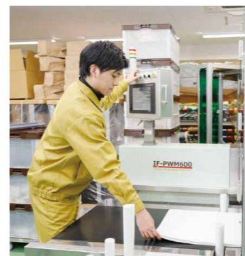
手作業の8倍速で毎時600本を巻き取る“ポスター巻取りテープ貼り装置”
