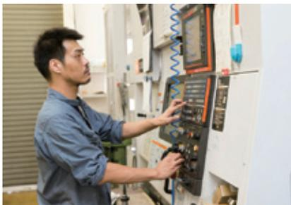
金属の塊を削って成型する旋盤加工の機械
