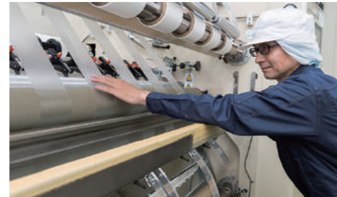
機械の張力などを調整しながら、むらなく巻き上げる。「この奥深い技術を後輩に伝えていきたい」と黒澤さん
