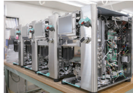
同社が世界に誇る「リサイクル分取HPLC」最新機の製造現場。この装置は国内外の研究者から愛用されている
