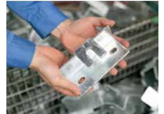
めっき加工後の各種部材。素材は鉄・銅・アルミなど様々で、素材によってめっきの難易度も異なる
