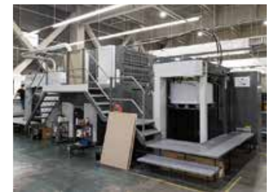
同社が使用する最新の印刷機。品質管理システムが搭載され、汚れや色ムラなどをチェックする機能を備える
