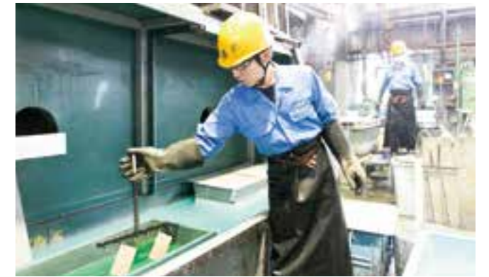
電気めっきを行う尾熊さん。一つずつ手作業でめっきを施していく多品種小ロットの生産体制で高い品質を維持している
