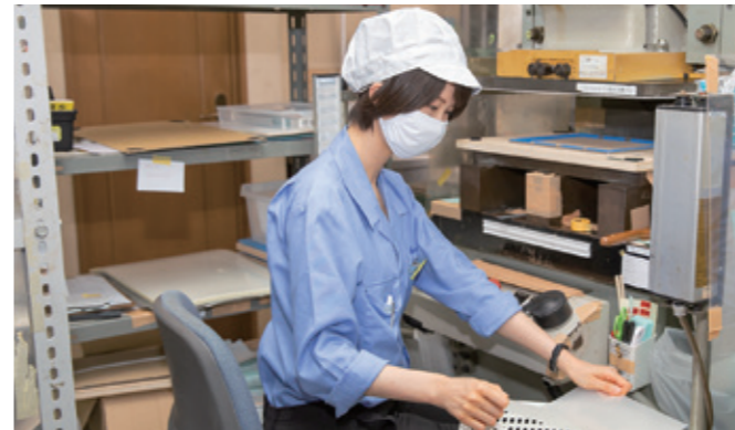
プレス機で作業する豊嶋さん。プラスチック板をエンボス加工して製品を成形した後、プレス加工の工程に入る
