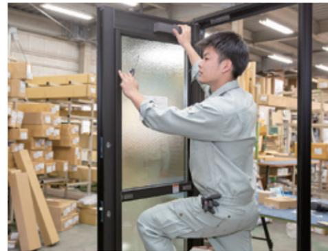
サッシやドアの組立ては同社1階の作業場で行う。組立てた上で配送し、現場でのスムーズな施工に備える
