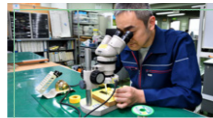
顕微鏡を使ってアンテナのはんだ付け。試作段階では実作業が多いという
