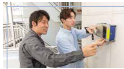
電磁波を使って建物内部に異状がないかを点検する機器。その使い方を指導する宮川主任(左)
