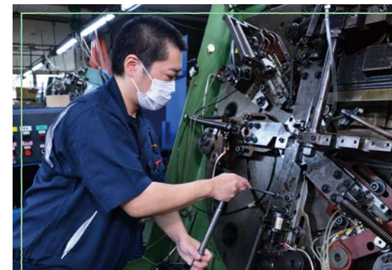
機械から金型を取り外す。「同じ機械でも製品によって金型が変わるので、傷つけないように慎重に作業します」(山田課長)
