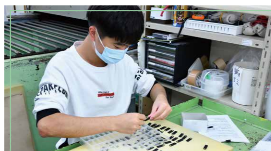
完成部品がむらなく塗装できているかチェックしながら、専用ケースに一つひとつ丁寧に納める
