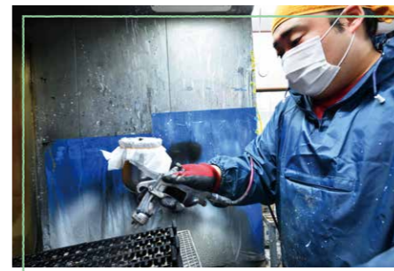
「部品の大きさや重さに合わせて、塗料を吹き付ける圧力を調整しています」(大塚さん)
