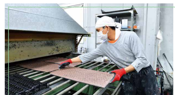
塗料をスプレーした部品を乾燥炉に運ぶ葛西さん。部品によって乾燥時間を調整することも大切な業務の一つ
