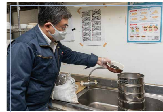
調査部では、技術部が採取してきた土をふるいにかけ、液状化する危険のある地盤かどうかの試験を行っている
