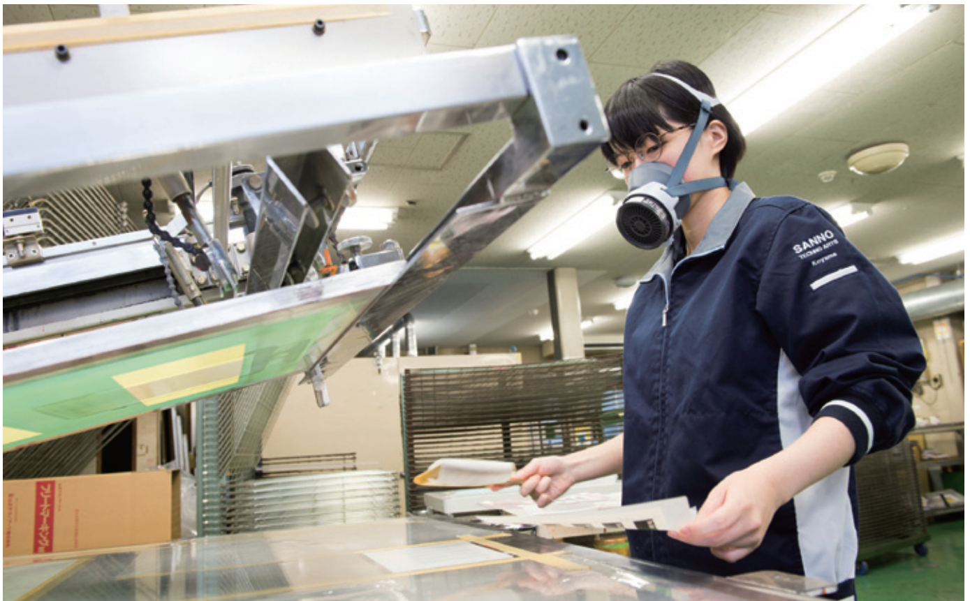
シルクスクリーン印刷機を操作する入社3年目の小山莉奈さん。微妙な加減が印刷の品質を左右する
