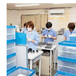
出荷前の検査風景。めっきを施した部品の表面に傷やムラがないかをしっかり確認する
