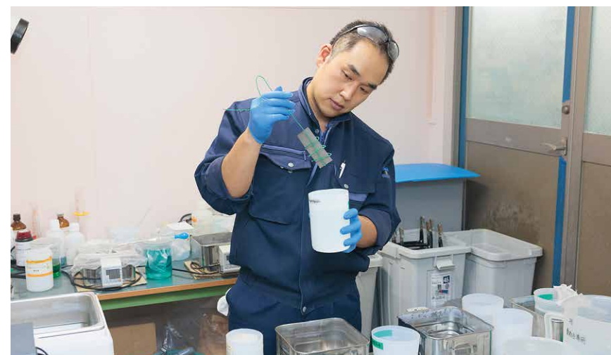
薬品をテストする日吉さん。材料の洗浄など、前処理の仕方次第でめっきの品質や生産性も変わる
