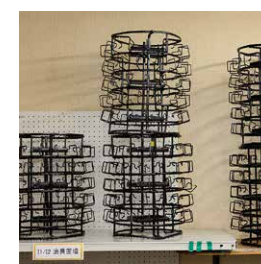
めっき処理のために材料を固定する治具。これらも自社で設計・開発している
