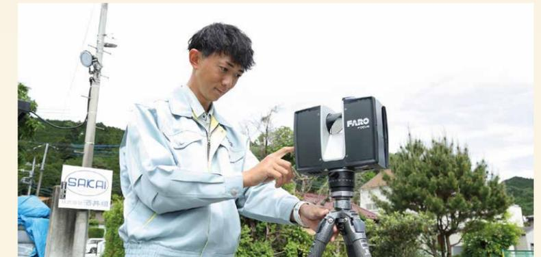
測量部で導入した3Dレーザースキャナーで測量中。ITを活用し事業領域を拡大している
