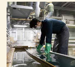
アルマイト加工の様子。電解液の中に部品を浸し、電気を通して皮膜を作る
