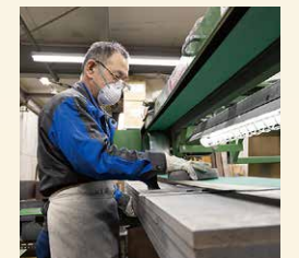
職人技によるヘアライン加工。アルミの表面にヤスリで微細な直線模様をつける
