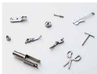
微細加工のサンプル。10ミリに満たないハサミで紙を切ることができる
