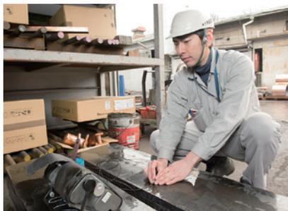
超音波を使って内部欠陥を探る「超音波探傷試験」中の五十嵐修さん
