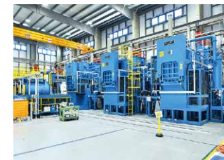
南工場。焼き入れ・焼き戻し工程を人の手に頼らない自動搬送機も導入
