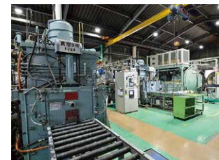
本社工場の一角。真空状態で熱処理を行う設備が10基近く並ぶ
