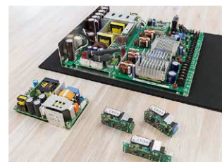
既製品を組み合わせてオリジナルの電源装置を製造する
