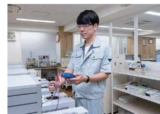
基準器との比較により、温度センサの精度を確認する校正作業中
