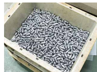
完成したグリスニップル。専用機で4秒に1個生産している
