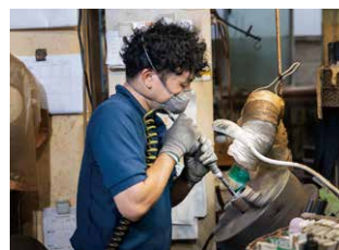
金型の研磨作業。研磨の具合が製品の仕上がりに影響する重要な工程
