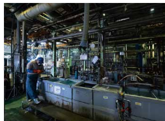
手作業のめっき工程のライン。薬品を扱う作業は慎重さが求められる
