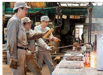
ソルトバスでの焼き入れ作業中。集中力と体力が必要
