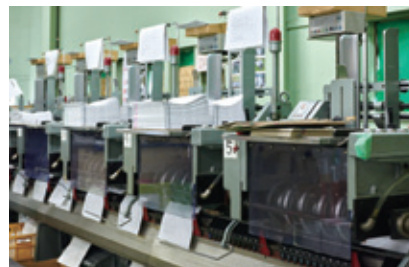
「剥がれスクラム製本」は製本機に独自の設定をすることで可能にした
