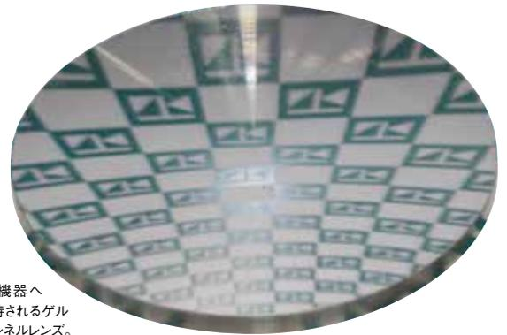
赤外線光学機器への応用が期待されるゲルマニウム製フレネルレンズ。
