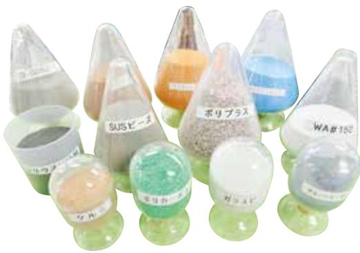
サンドブラスト処理に欠かせない研磨材の種類は材質、粒の大きさなどを合わせると約400種類ほどある。
