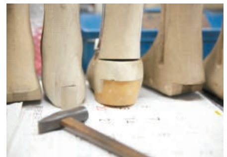
木製義足のかかと部分にゴムをはめる。別素材を組み合わせるため、難しい加工になる
