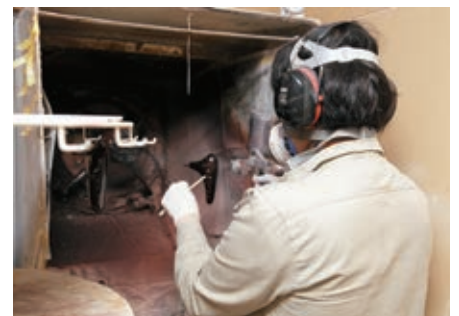
エアガンを使って塗装して仕上げる。塗りむらが出ないようにするのも技術が必要
