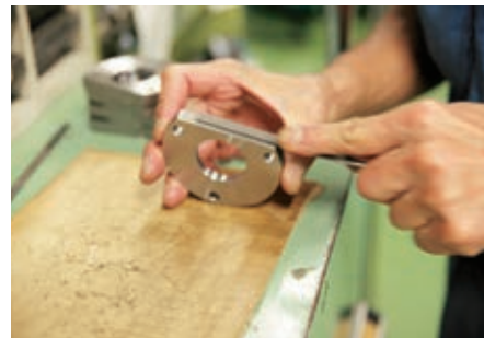
工作機械で加工した精密部品を、最後は手で仕上げることもある
