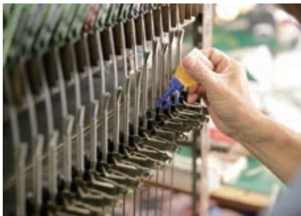
シース熱電対を1本ずつ手作業で製造
