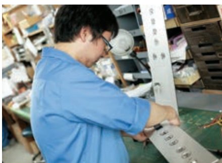
階数やボタン配置の違いを踏まえ、操作盤は1点ずつ手で組み立て
