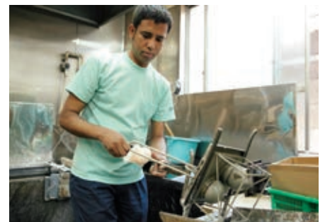
職人の技量が問われるスラッシュ成形。金型で1点ずつ製作していく
