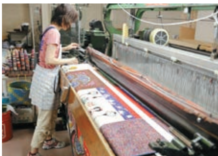
シェニール織の作業風景。手作業で加工するため、1日に3~4mほどしか織り進めない
