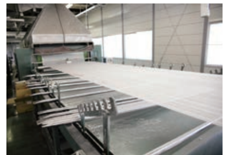
タオルを織る前にのり付け。のりの量をできるだけ減らすことで、吸水性が高くなる
