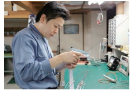
出荷前の検査中。不良が混ざっていないか、温度は正確に測れるかと確かめる
