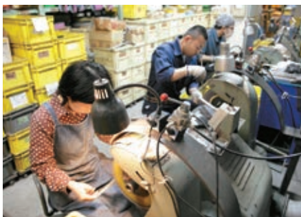
鍛造した金属を寸法どおりに仕上げるため、研磨して微調整
