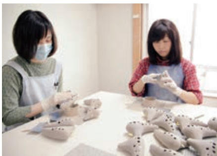
焼成後のオカリナを磨いて形を整える。ここから何度も音程を確かめながら仕上げている
