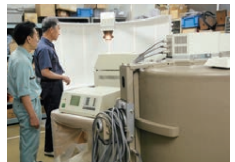
めまいの検査装置も扱う。白いスクリーンに光を走らせ、目で動きを追わせて検査する
