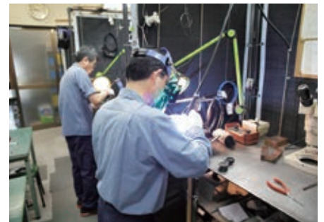
シース管に熱電対素線を入れ、溶接するなどして組み立てていく
