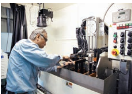
非破壊検査装置の内部を点検中。大規模な装置を作ること もよくある
