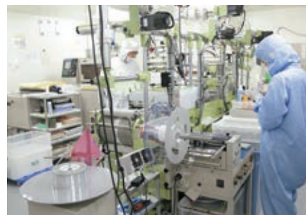
手前の装置では、スマートフォンの中で部品を固定するための テープを製造
