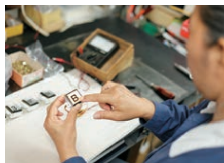
組み立てたボタンは1点ずつ、電気が通るか、ちゃんと光るかと検査
