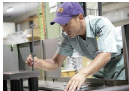
加工品の測定中。温度の高低によって金属は伸縮するため、大型部品ほど高精度を出しづらい
