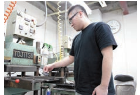
押出成形だけでなく、金型成形にも対応。写真は金型成形でゴム製品を作る様子
