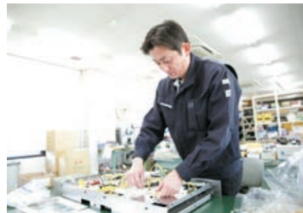
運行会社ごとの要望に合わせた設計にするため、同じ行先表示器でも、組み立て方が少しずつ異なってくる
