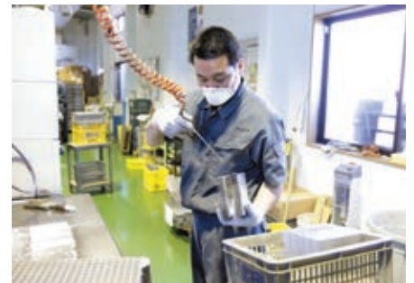
巨大な金属板を、製品1点分の大きさに切断。エアーを吹き付けて、金属くずなどを取り除く
