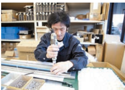
バスは走行時に揺れることが多い。ねじが緩まないようにしっかり締めることが大切だ
