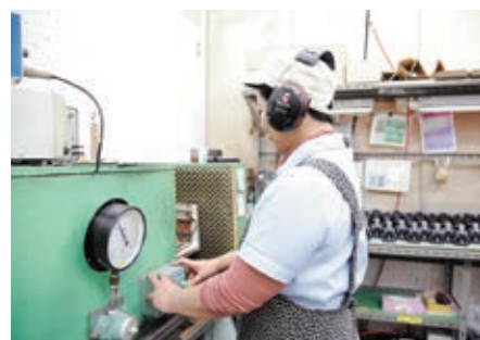
ホーンの検査。大きな音が鳴るため耳当てをして対策
