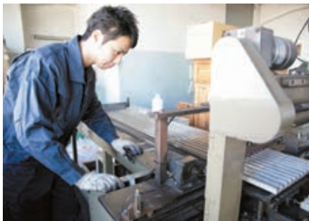
大室さんが担当する原材料を切断する工程。バーナーで熱し、急冷して切断
