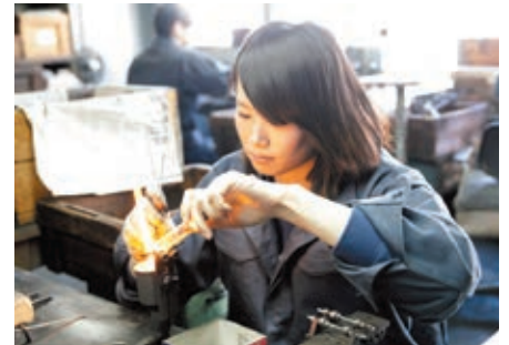
特注品の注射筒を火で加熱しながら加工。若手が高精度に加工し、同業者から驚かされている
