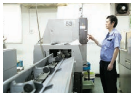
NC自動旋盤は自動的に部品加工してくれるが、段取り・加工手順次第で精度に差が出る
