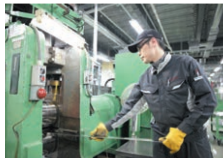
溶解して合金にした金属塊を圧延機で薄く延ばしていく
