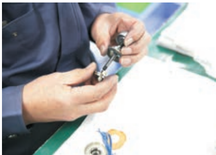
精密測定機の組み立て。担当者の技量が最終的な精度に影響する
