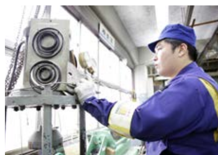
出荷前には、バルブに気体の漏れなどがいないかと入念に検査
