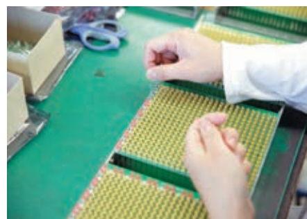
LEDを隙間なく詰めていく工程。指定した場所のLEDを光らせることで行先を表示する
