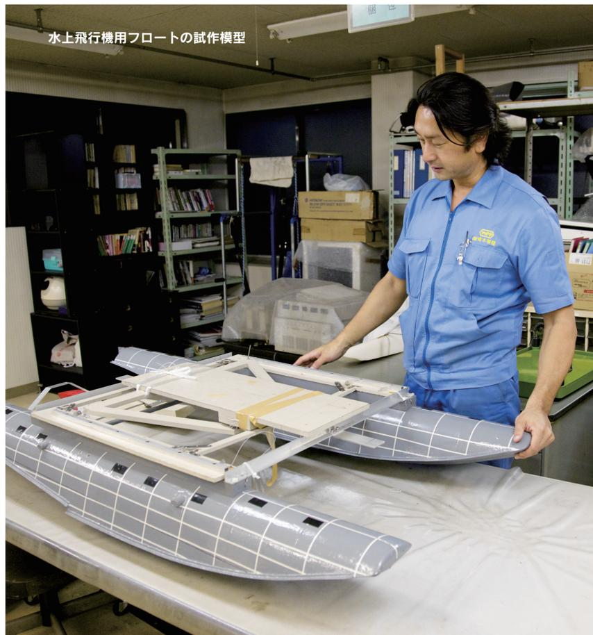
水上飛行機用フロートの試作模型
