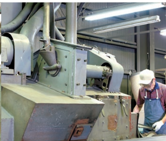
職人の手で支えながらサンドブラスト加工をする
