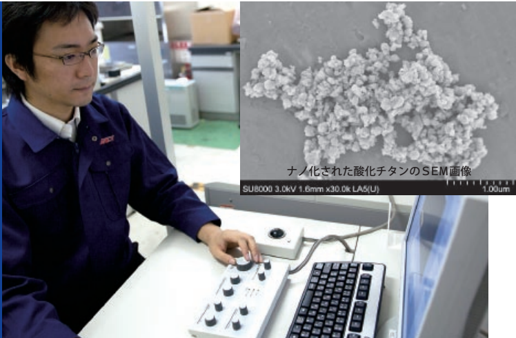
ナノ粉碎機「NP-100」で粉碎処理した材料を評価するため、電子顕微鏡を操作する高塚さん
