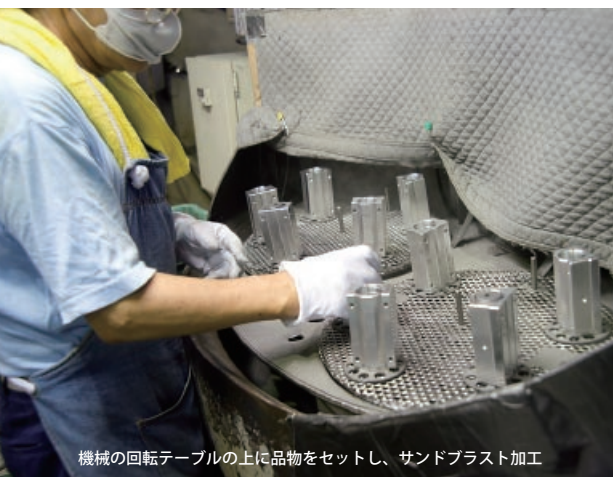
職人の手で支えながらサンドブラスト加工をする
