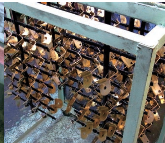
部品を溶液中に漬けてめっき加工を施す
